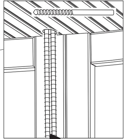
Värmebeständig kabel (170°C)
