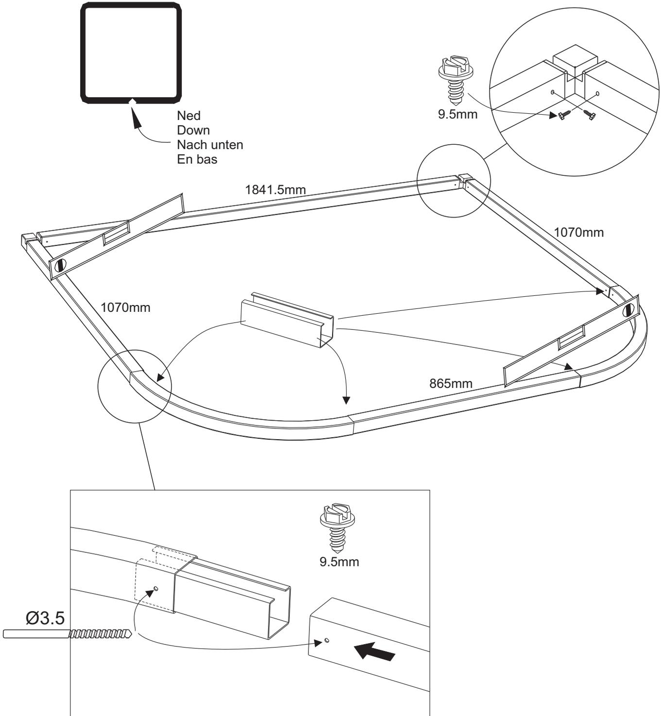
Lägg ut golvramarna. Kontrollera att ramen ligger plant, använd vattenpass. Är ramen inte plan, justera genom att palla upp på nödvändiga ställen under golvramen. OBS! Det är ett absolut krav att golvramen ligger plant "i våg" för att slutresultatet skall bli perfekt.
